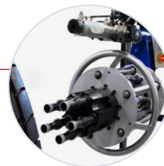
Teste multimandrino con avvitamento sincronizzato
